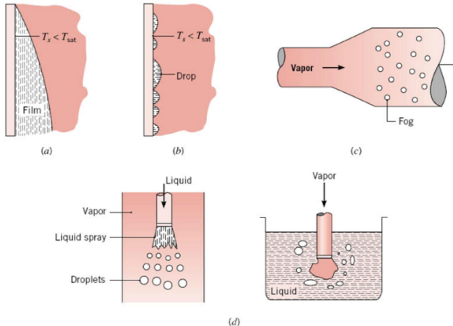
(a) Condensação em filme (b) Condensação em gotas (c) Condensação homogênea
