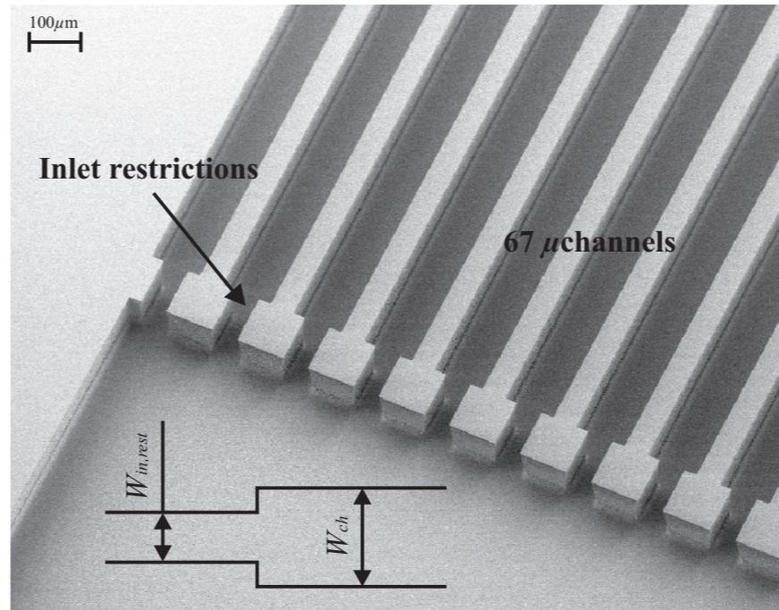
trocador de calor de microcanal para CPU
