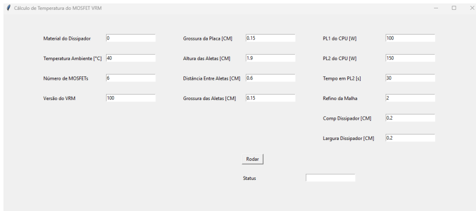
Figura 3.9: Interface gráfica do software desenvolvido com inputs inseridos para o caso de referência.
