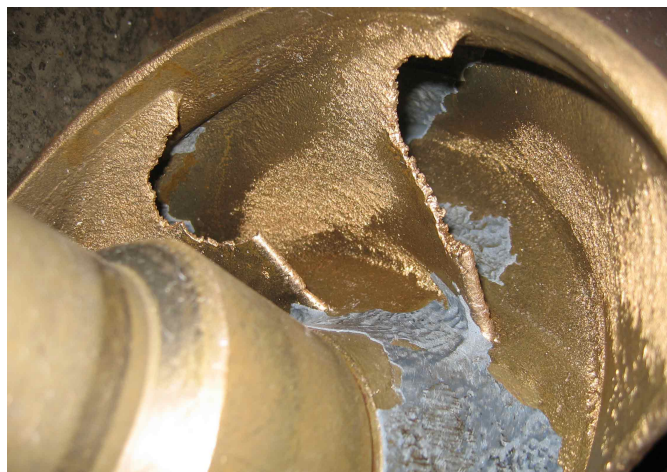
Figura 1: Erosão em um impelidor causada pela cavitação.
