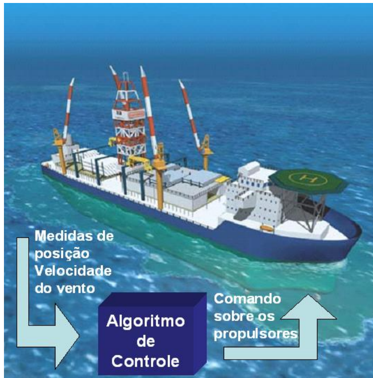
Figura 2.16: Esquemático Simples do Sistema de Posicionamento Dinâmico - Retirado de [20]
