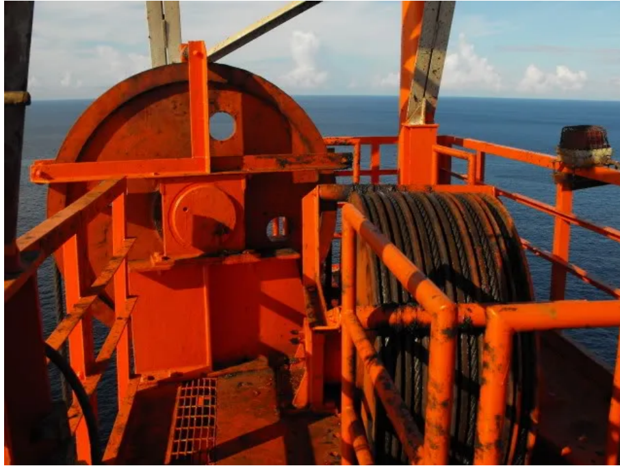
Figura 2.3: Bloco de Coroamento - Retirado de [5]
