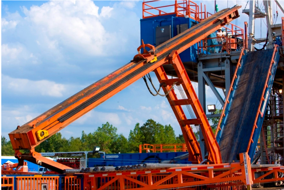
Figura 2.2: Passarela de Tubos - Retirado de [6]
