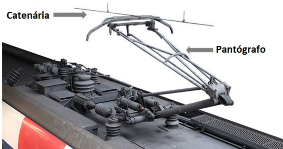
Figura 2.5: Alimentação via aérea com coleta por pantógrafos. [Adaptado de 10]
