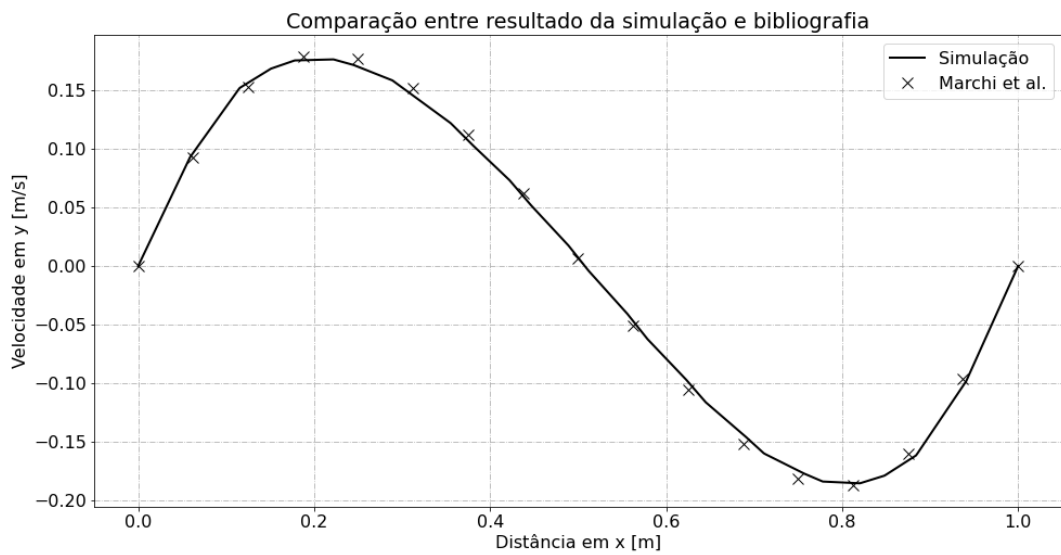
Figura 4.7: Resultados de velocidade em Y da simulação do caso Lid-driven
