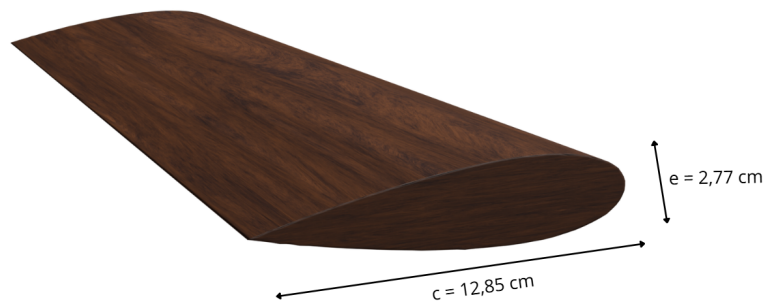
Figura 1.1: Aerofólio em análise: Perfil simétrico confeccionado em madeira com corda de 12,85 cm e espessura máxima de 2,77 cm.
