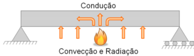
Figura 1 – Processos de transferência de calor atuantes em uma viga
