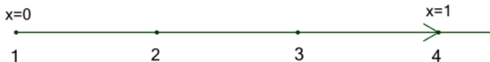
Figura 15 – Discretização de domínio unidimensional
