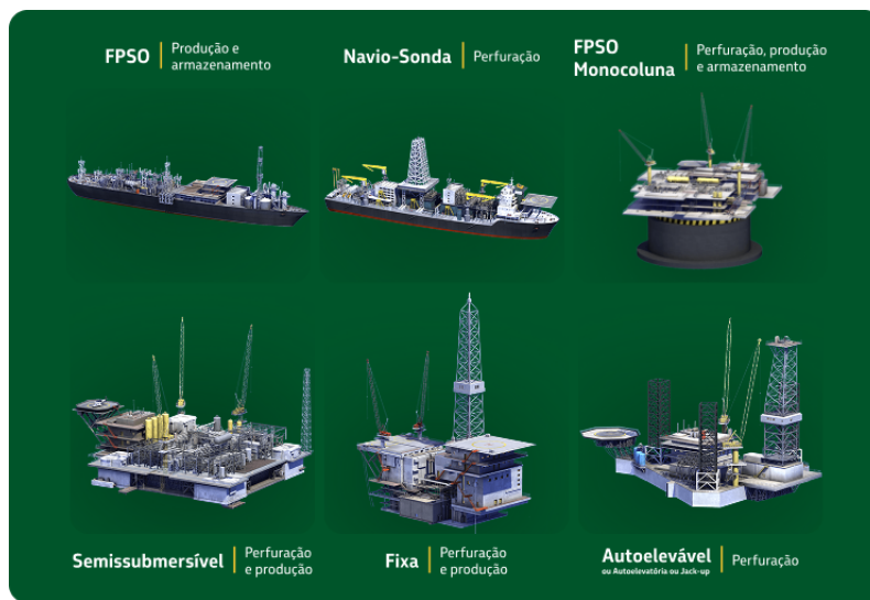
Figura 2.1: Tipos de plataforma de petróleo e suas finalidades. Fonte: [5]
