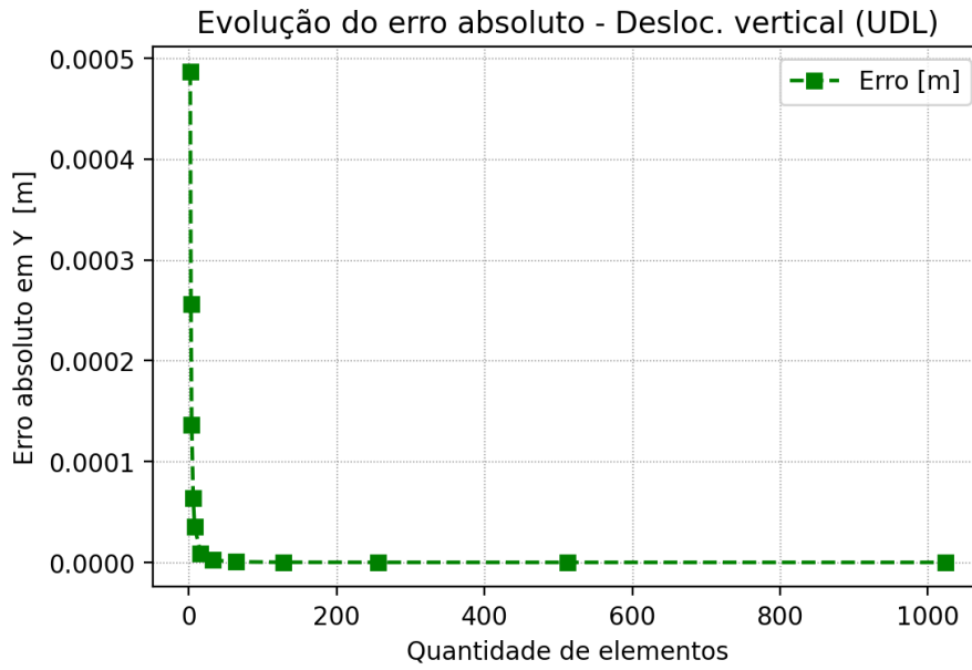
Figura 4.6: Convergência do erro absoluto do deslocamento
