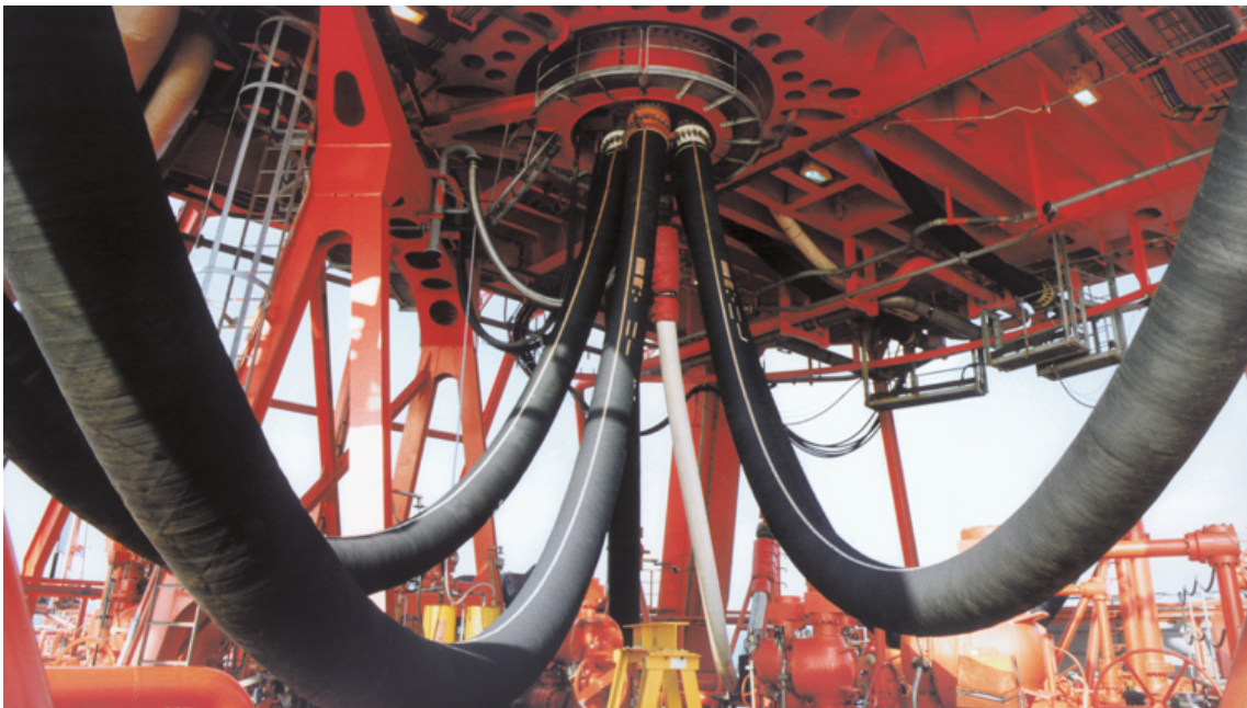
Figura 2.6: Mangueiras de abastecimento de petroleiros numa plataforma off-shore
