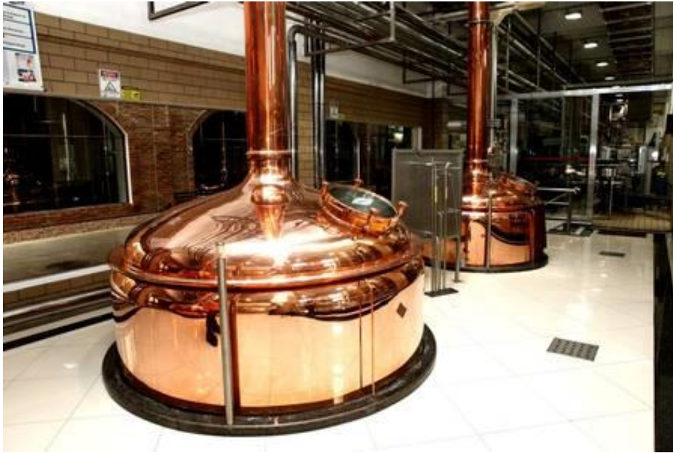
Figura 5 – Tina de Mostura onde é feito a Fervura do mosto
