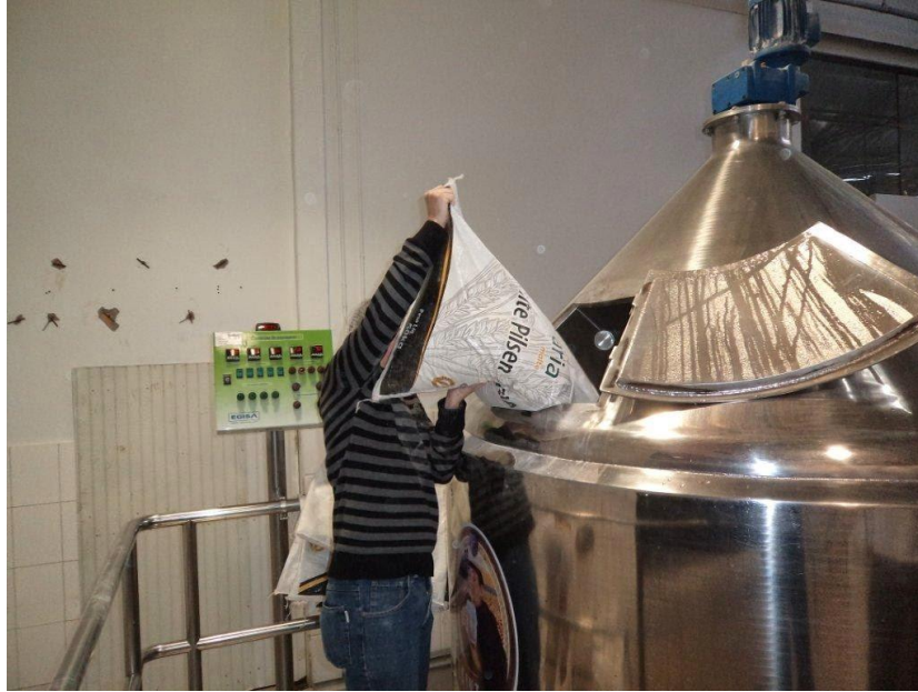
Figura 2 -Arriando o malte na Tina de Mostura Fonte: http://monicheascervejas.blogspot.com.br
