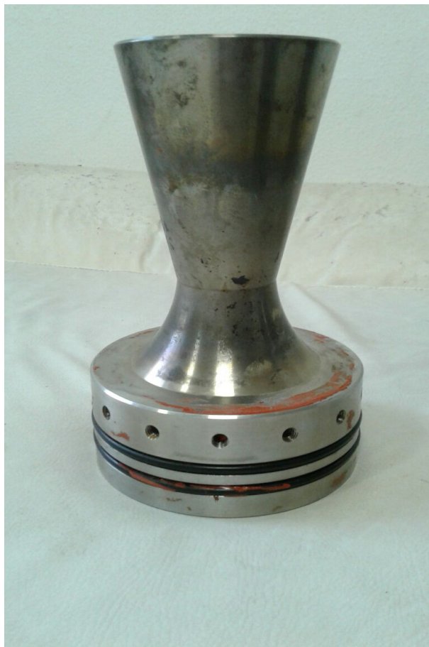
Figura 4 - Tubeira usinada em aço inox utilizada em minifoguete pelo Grupo de Foguetes do Rio de Janeiro.
