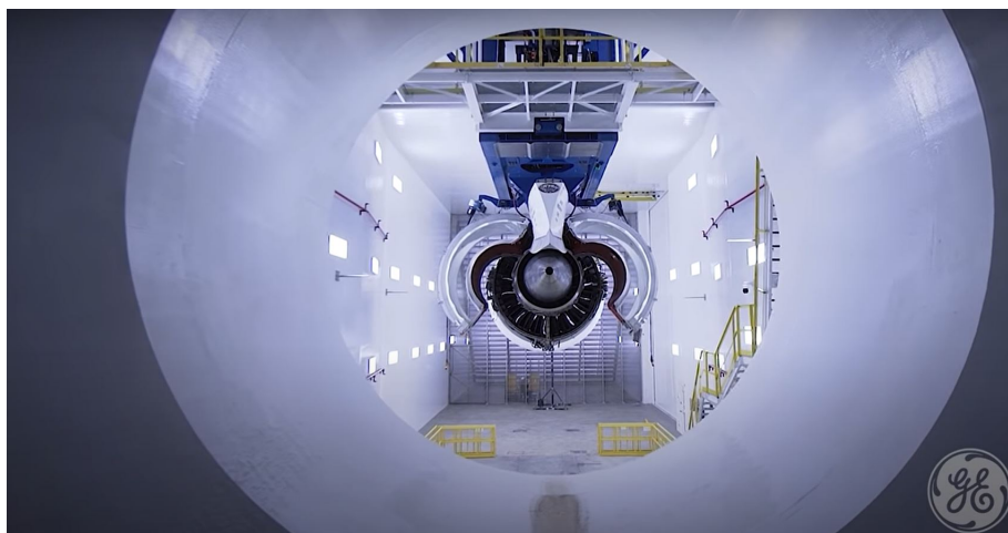
Figura 2.5: Vista da seção de trabalho pelo duto (célula da GE Aviação em Três Rios)
