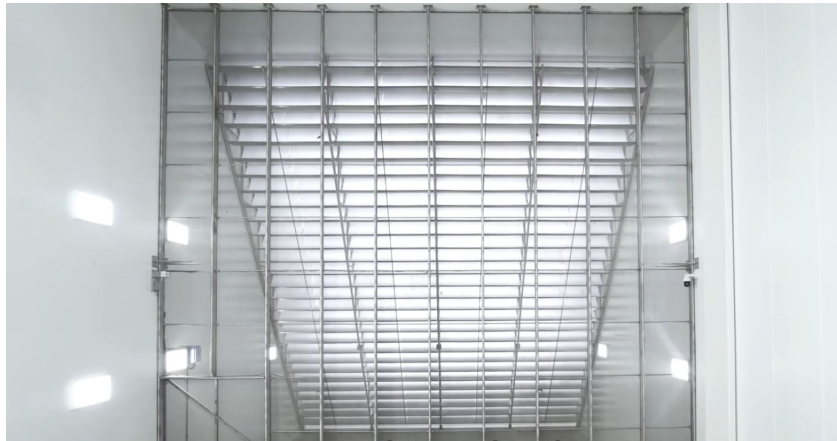
Figura 2.4: Tela porosa e defletores ao fundo no banco de provas da GE Aviação em Três Rios
