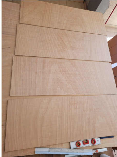
Figura 3.10: Peças já cortadas para construção do componente Câmara de Teste do Túnel de Vento. Fonte: Autoria Própria.
