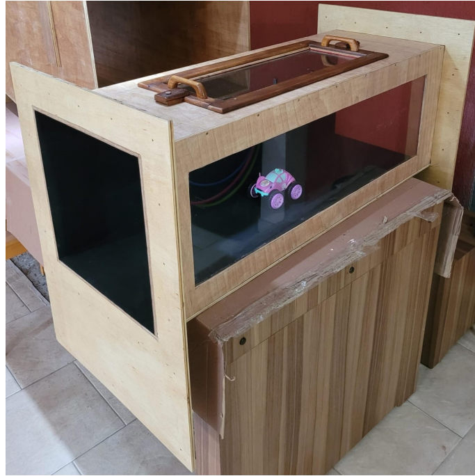
Figura 3.13: Câmara de Testes com as placas de acrílico e com o suporte do tipo escotilha com duas tramelas. Fonte: Autoria Própria.
