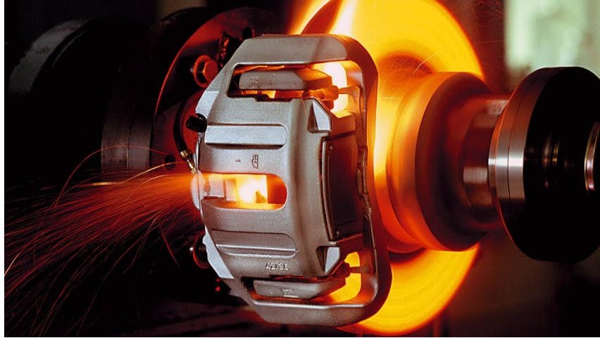
Figura 2.15: Pinça de freio proporcionando atrito ao disco de freios
