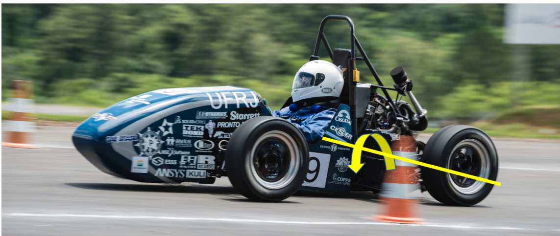
Figura 2.3: Pitch causado pela transferência de carga e de massa na frenagem
